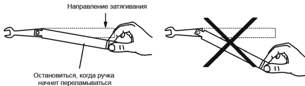
Рисунок 3-8 Использование динамометрического ключа
