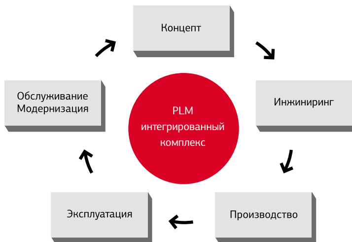
Рис. 2. PLM-управление жизненным циклом изделия
