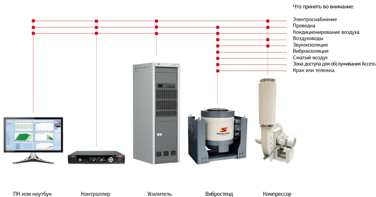
Акценты при подготовке размещения системы виброиспытаний
