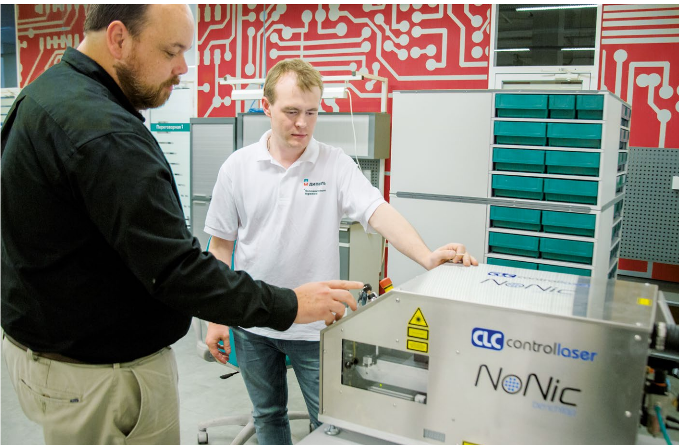
Машины серии NoNic для лазерной зачистки проводов и кабелей в демозале компании «Диполь»
