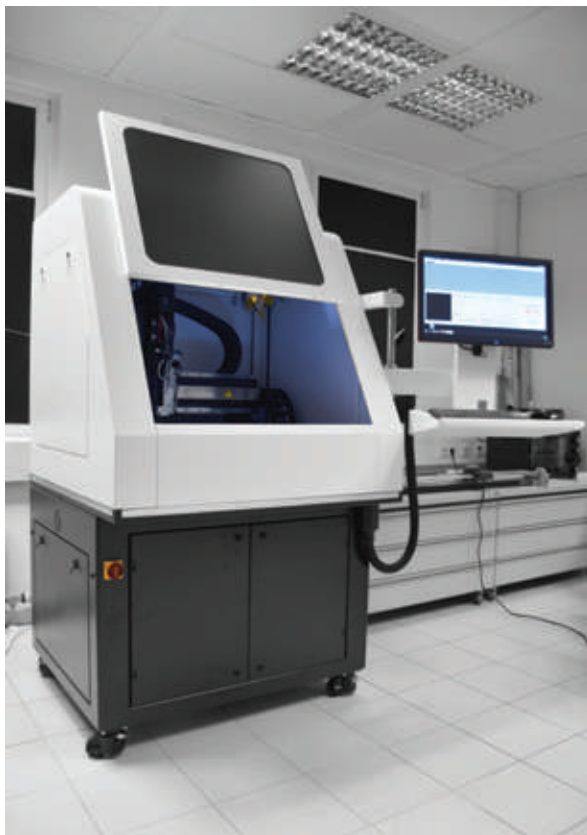
Рис 2. Установка 12XXX: все в одном корпусе, занимаемая площадь порядка 1м 2
