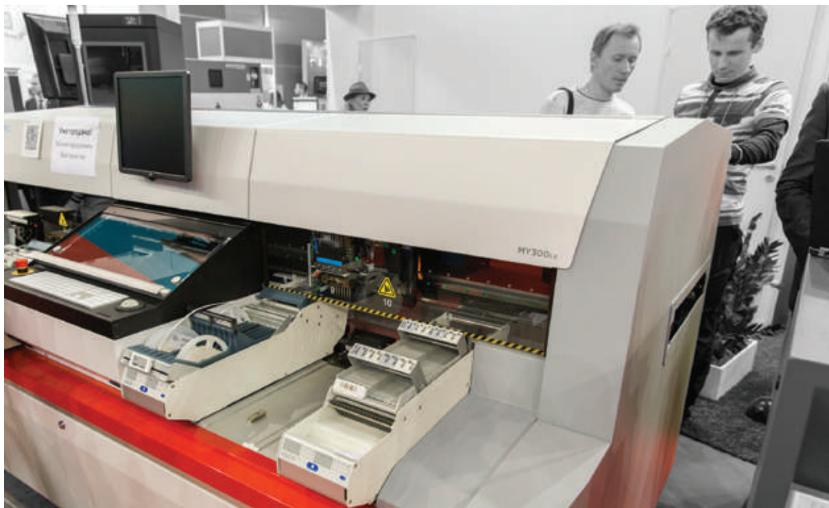
Рис. 9. Автомат для монтажа SMD-компонентов Mycronic MY300
