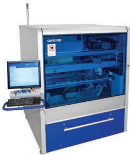
Censcorp 1500 OF. Автоматизированный установщик с возможностью размещения большего количества питателей
