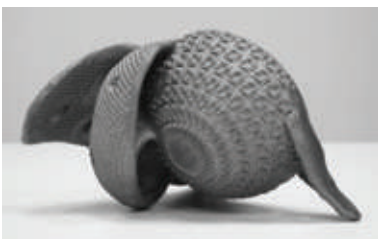
Рис. 16. Имплантат из отечественного титана VT6
