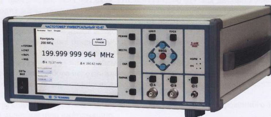
Рисунок 1 - Общий вид частотомера универсального ЧЗ-97
