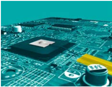
Рис. 1а. Крепление термопары сверху к корпусу BGA-компонента
