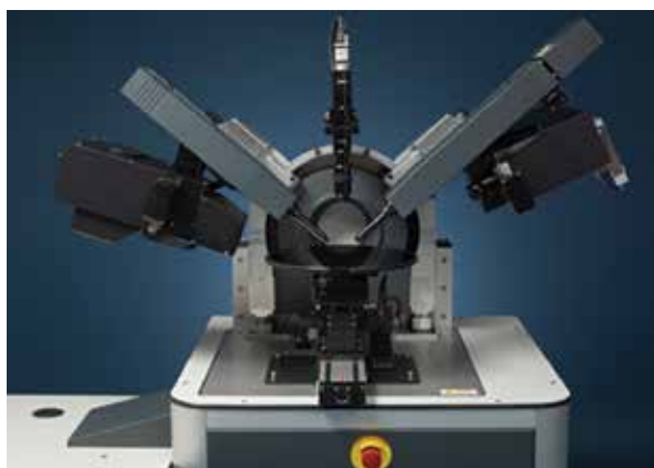
Рис. 5. Уникальный ИК-эллипсометр Semilab с диапазоном длин волн 190 нм — 25 мкм
