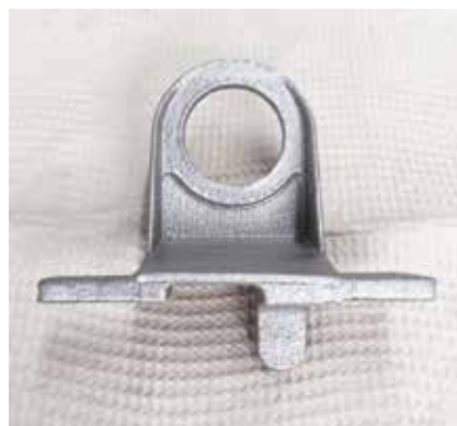
Рис. 12. Примеры изделий, полученных методом DMT. Важным требованием при их изготовлении является достижение высокой прочности без термической обработки
