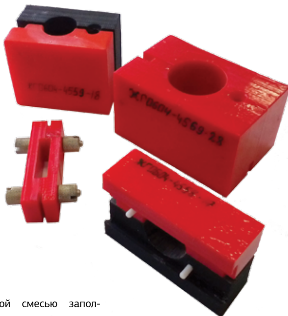
Рис. 2.1. Вариант оснастки для бескорпусной заливки соединителей
