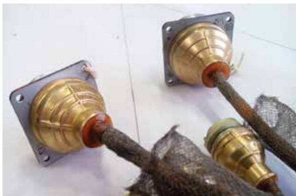
Рис. 1. Залитый жгут (бескорпусная заливка)
