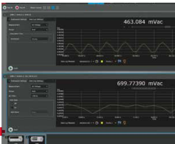
Рис. 5. На графике представлено наиболее точное измерение 1/10 В RMS мультиметром 34465А (нижняя панель измерения)
