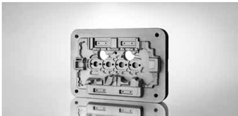
Рис. 6. Литьевая форма для головки блока цилиндров двигателя. Основа изготовлена из стали H13, антикоррозионное покрытие выполнено из сплава Hastelloy C22 методом DMT
