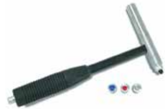
Рис. 16. Ударный молоток, оснащенный тензодатчиком для измерения вынуждающей силы, с наконечниками различной твердости
