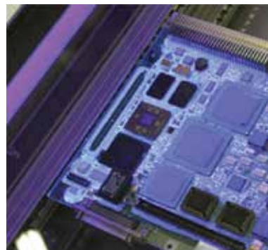
Рис. 1. Печатная плата, покрытая УФ-лаком (селективное покрытие, в темных областях покрытие отсутствует)
