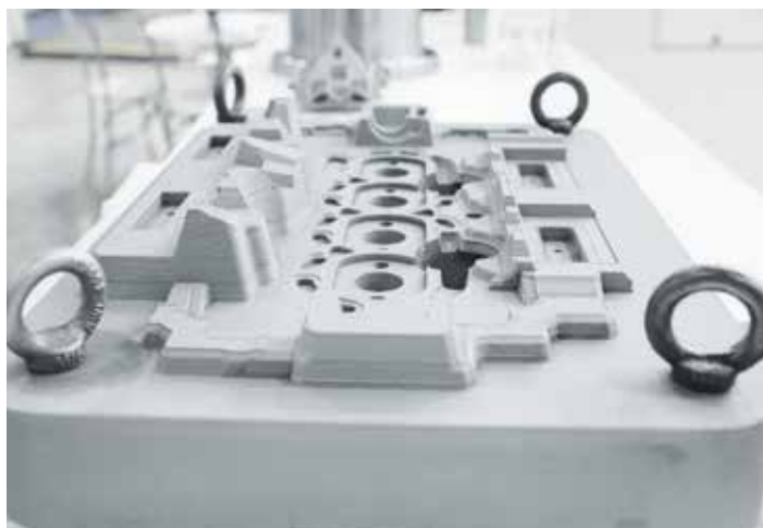
Рис. 11. Литьевая форма блока головки цилиндров с антикоррозионным покрытием
