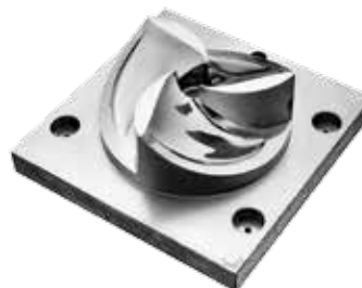
Изделие после механической постобработки
