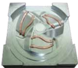
Подготовка изделия для гибридного метода производства с помощью технологии DMT
