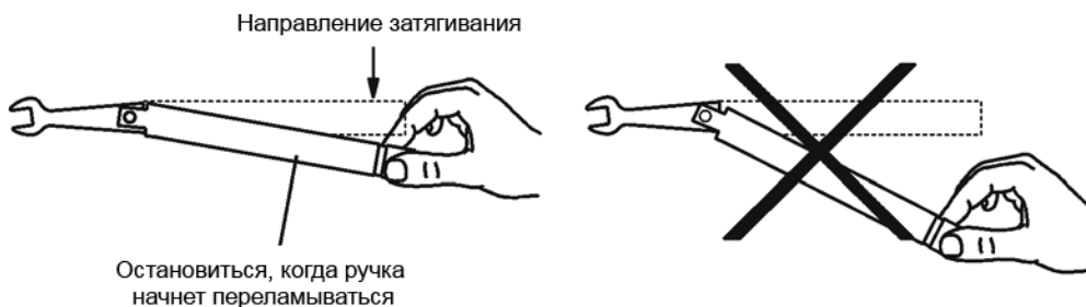
Рисунок 3-7 Использование динамометрического ключа
