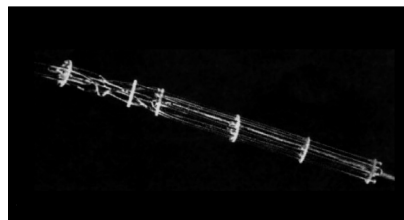
Рисунок 36. Платиновый резистивный датчик температуры в виде клетки
