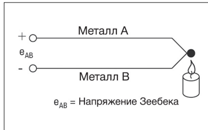
Рисунок 3. Напряжение Зеебека пропорционально изменению температуры
