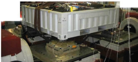
Рис. 3. Установка для горизонтального испытания 3-тонного 8-футового стандартного контейнера
