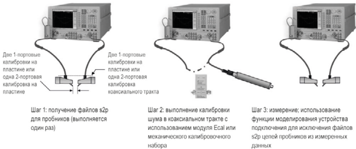
Рис. 7. Исключение цепей пробников зондовой станции представляет собой другой способ получения калиброванных результатов измерений
