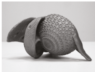
Пример 3D-печати. Имплантат из отечественного титана BT6
