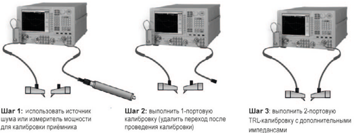
Рис. 6. Мастер калибровки коэффициента шума автоматически встраивает потери, вносимые пробником (зондом) в данные шумовых параметров, чтобы переместить опорную плоскость калибровки к опорной плоскости 2-портовой калибровки
