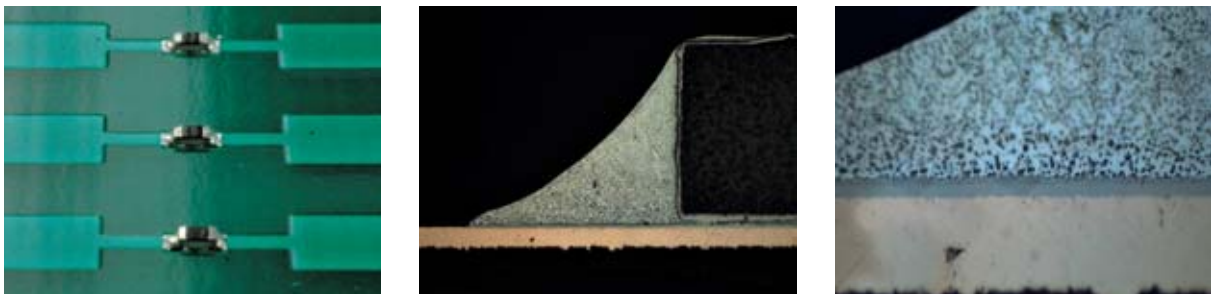
Рис. 9. Применение паяльной пасты INDIUM smt92H: вид паяных соединений на печатной плате (а); поперечное сечение IND/NiAu (б); поперечное сечение слоя интерметаллида (3,82 мкм) и барьерного слоя Ni (8,0 мкм) между печатной платой и припоем (в)
