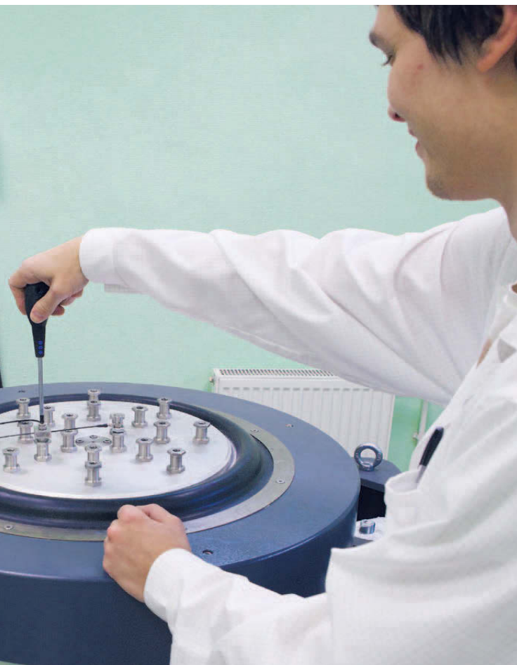
Рис. 1. Инженер-испытатель устанавливает датчик обратной связи (акселерометр) на вибростенде Sentek Dynamics M3240A
