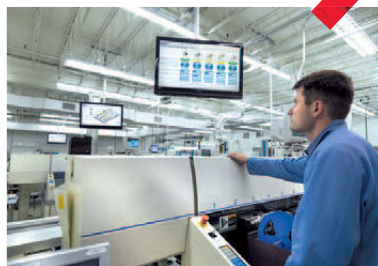
Информационная панель на линии. На таких мониторах информация отображается в режиме реального времени для своевременного обеспечения данными операторов
