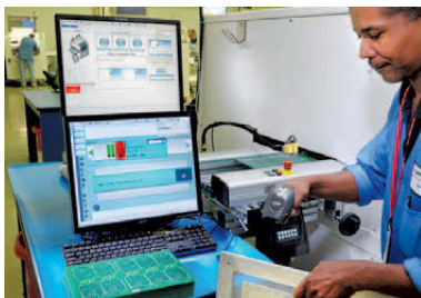
Сканирование штрих-кода трафарета. Система проверяет инструменты, материалы, питатели, персонал, программы для машин перед разрешением процесса
