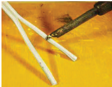
Рис. 5. Снятие изоляции с провода паяльником
