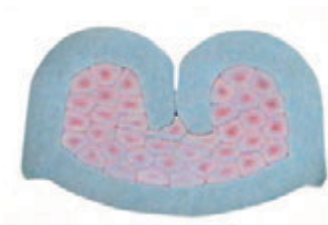
Рис. 18. Визуальный анализ среза обжатого провода
