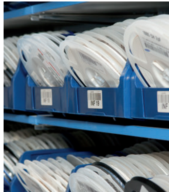
Рис. 5. Адресное хранение SMD-компонентов на складе.
