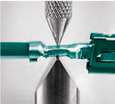
Рис. 17. Измерение высоты обжима
