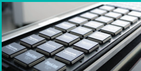
Стол-питатель: ориентирован на малые серии, занимает много места (два-три поддона на один слот)
