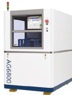
Аналог установки утонения Disco DFG8540 (Ø100-200мм, fine/coarse grinding)
