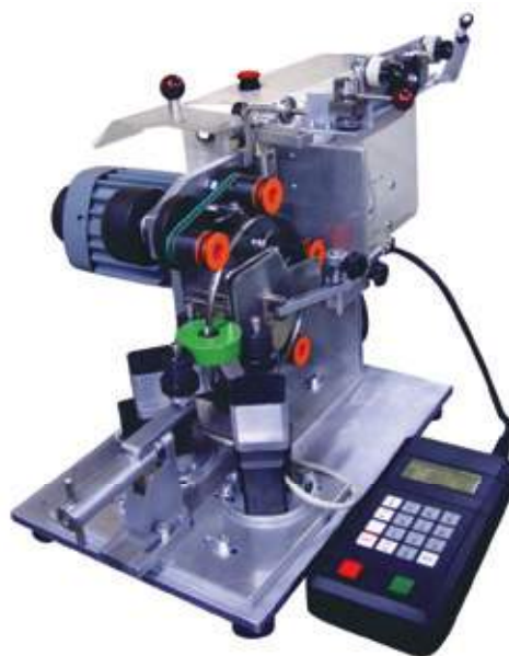
Рис. 12. Станок тороидальной намотки TU-150 для намотки миниатюрных торов
