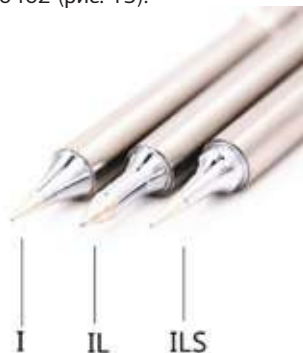
Рис. 13. Пайка QFP-компонента наконечником формы I. Очень тонкий наконечник позволяет легко припаять крошечный чип
