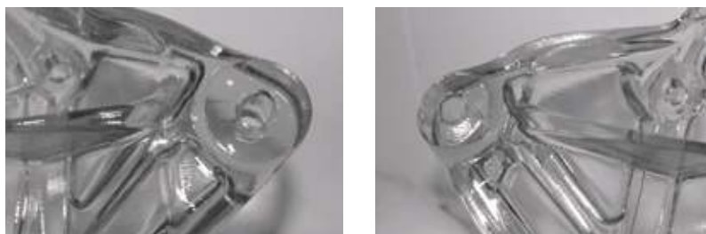
Рис. 5. Изделие из материала Somos WaterShed 11120
