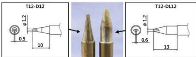
Рис. 8. Сравнение наконечников T12-D12 и T12-DL12
