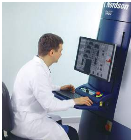
Станция рентген-контроля для проверки качества монтажа (ООО «Прософт-Системы»)
