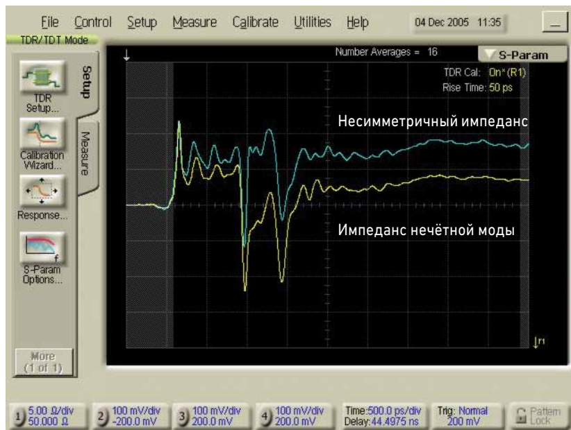
Рисунок 57. Сравнение измеренного несимметричного импеданса с импедансом нечётной моды одной длинной линии на материнской плате.
