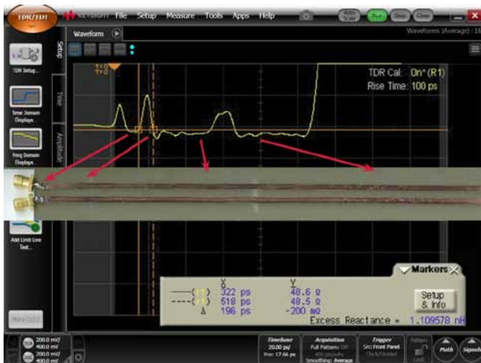
Рисунок 44. Рефлектограмма несимметричной линии передачи, пересекающей зазоры в проводнике цепи обратного тока, демонстрирует индуктивные неоднородности.
