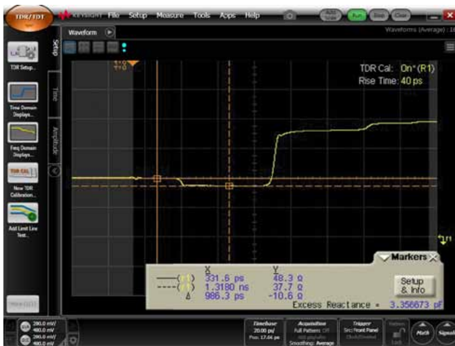
Рисунок 2. Применение маркеров для измерения волнового сопротивления линии передачи.
