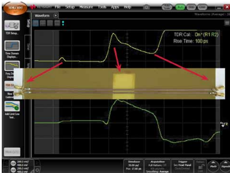
Рисунок 47. Измеренная рефлектограмма одиночной линии, пересекающей большой зазор в проводнике цепи обратного тока, и шум скачка потенциала земли в пассивной линии.
