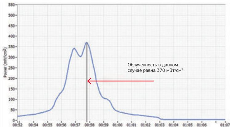
Рис. 5. Зависимость облученности от времени, измеренная в печи DIMA UV-522. Диапазон УФ-А (EIT 320-390)
