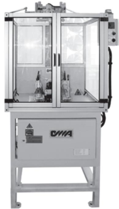
Рис. 7. Установка перемотки отечественной проволоки на катушки
