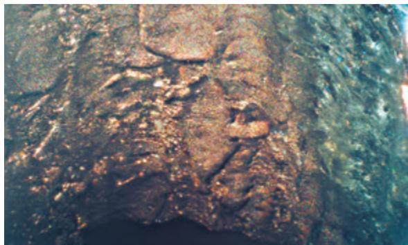
Рис. 7. Слой фоторезиста на внутренних стенках отверстия (диаметр отверстия 300 мкм)
