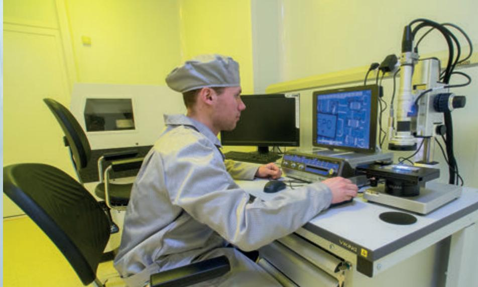
Рис. 9. Рабочее место, оборудованное ультразвуковым микроскопом
