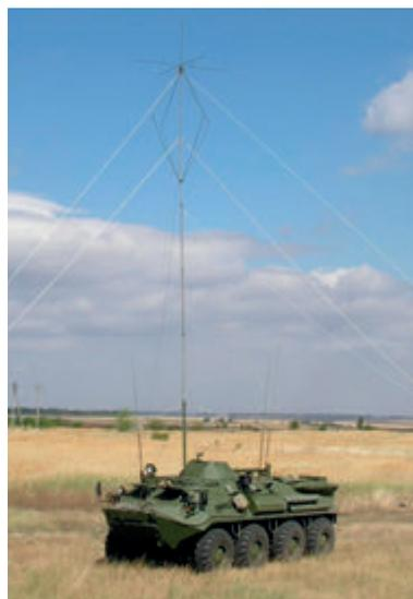
Рис. 3. Комбинированная радиостанция Р-145БМ 1 предназначена для организации радиосвязи с наземными объектами, проводной связи с внешними абонентами как в составе подвижных узлов связи, так и автономно
