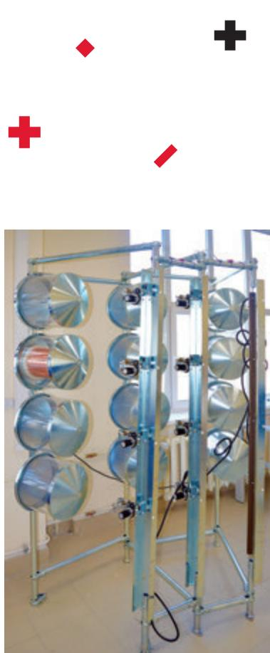
Рис. 6. Шпулярник — размещение катушек с отечественной проволокой
