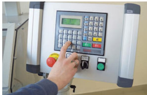
Рис. 8. Программирование плотности оплетения жгута
