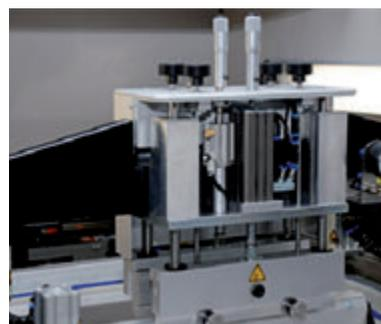
Рис. 2. Пневматическая головка печати с обратной связью
