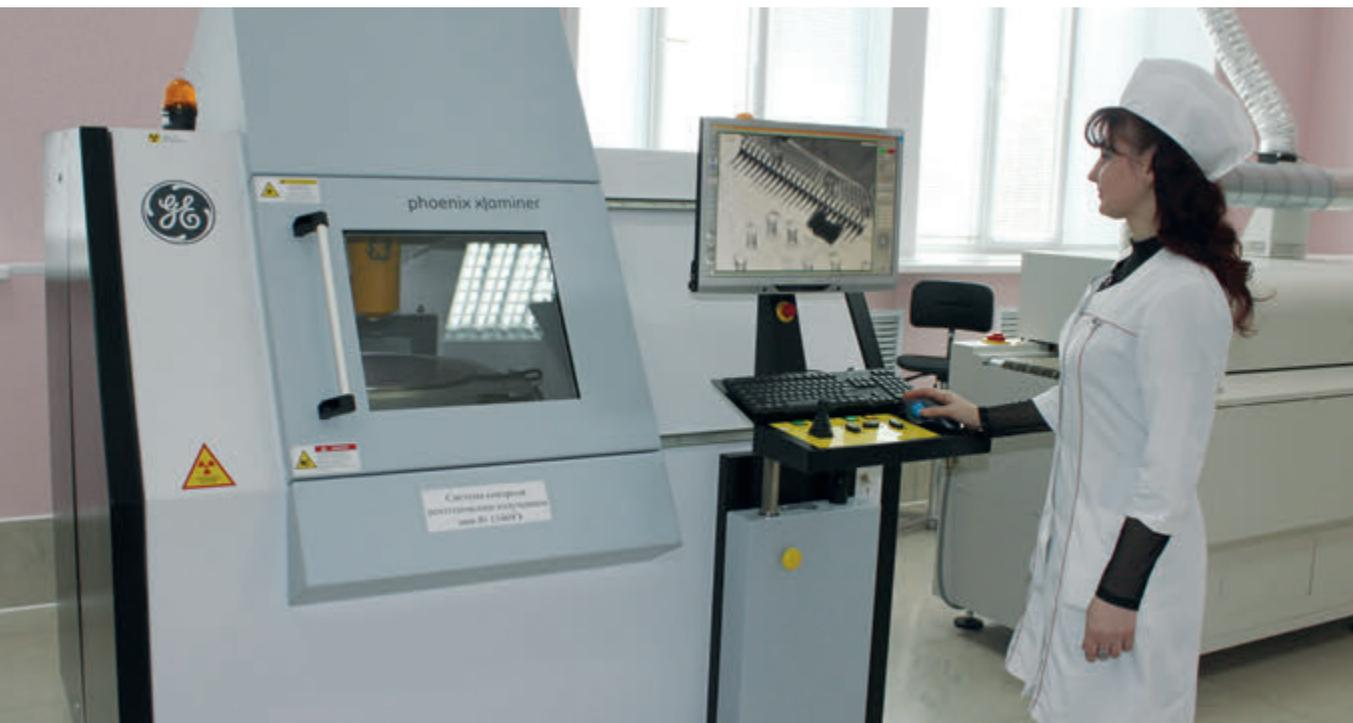
Рис. 2. Проверка качества пайки с помощью установки рентгеновского контроля
