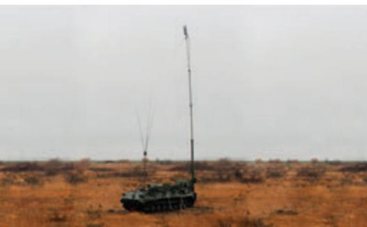
Рис. 4. Комбинированная радиостанция Р-142НСА, предназначенная для обеспечения управления и радиосвязи
