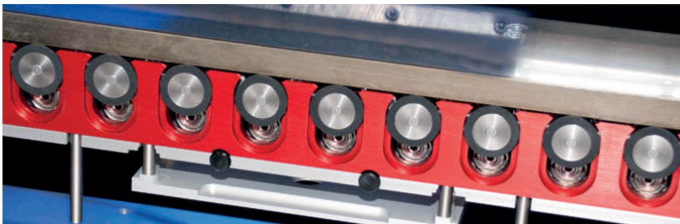
Рис. 9. Дисконная транспортная система
