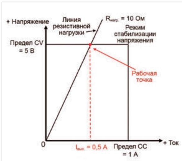
Рис. 3. Выходная вольт-амперная характеристика источника питания в режиме стабилизации напряжения
