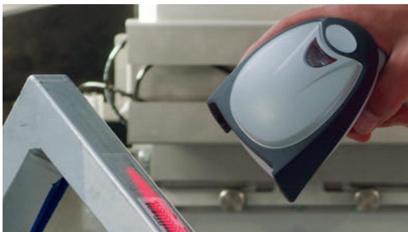
Рис. 10. Процесс считывания штрих-кода с трафарета
