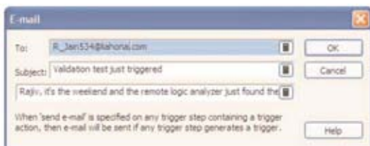
Рисунок 19 - При дистанционном управлении можно запрограммировать анализатор на посылку сообщения электронной почты, когда он обнаружит условие запуска и выполнит сбор данных, характеризующий состояние испытуемой системы.
