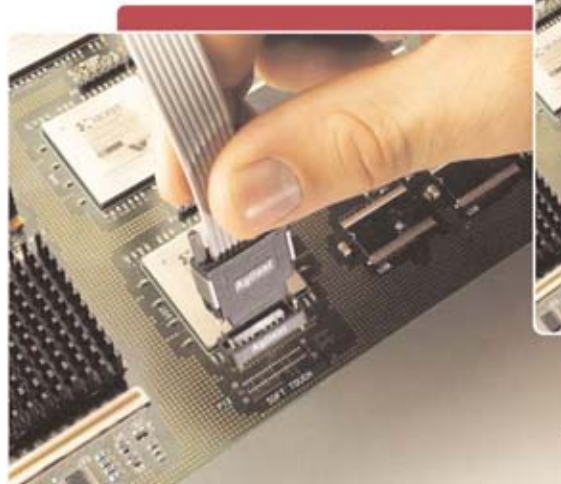
Рисунок 9 - Компактный 17-канальный пробник Softtouch идеален при плотном монтаже и в случаях, когда требуется подключить небольшое число сигналов.
