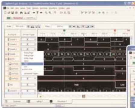
Рисунок 16 - Задание простого условия запуска в виде комбинации логических уровней, перепадов, кодовых слов и глитчей на множестве сигналов и шин.
