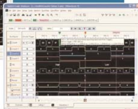
Рисунок 25 - Выполнение быстрых измерений временных интервалов между сигналами шин с помощью общих маркеров.
