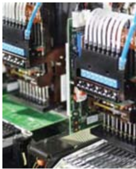
Рис. 3. Два независимых блока установочных головок
