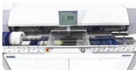
Рис. 6. В компактные установщики серии MY100 загружается до 160 питателей
