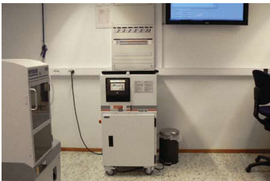
Рис. 5. Парофазная печь ASSCON
