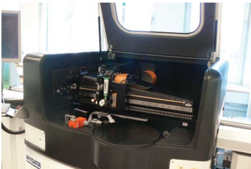
Рис. 4. Демонстрация работы бестрафаретного принтера MY500
