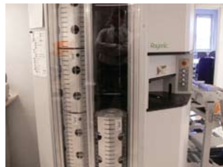
Рис. 6. Система хранения компонентов ROYONIC
