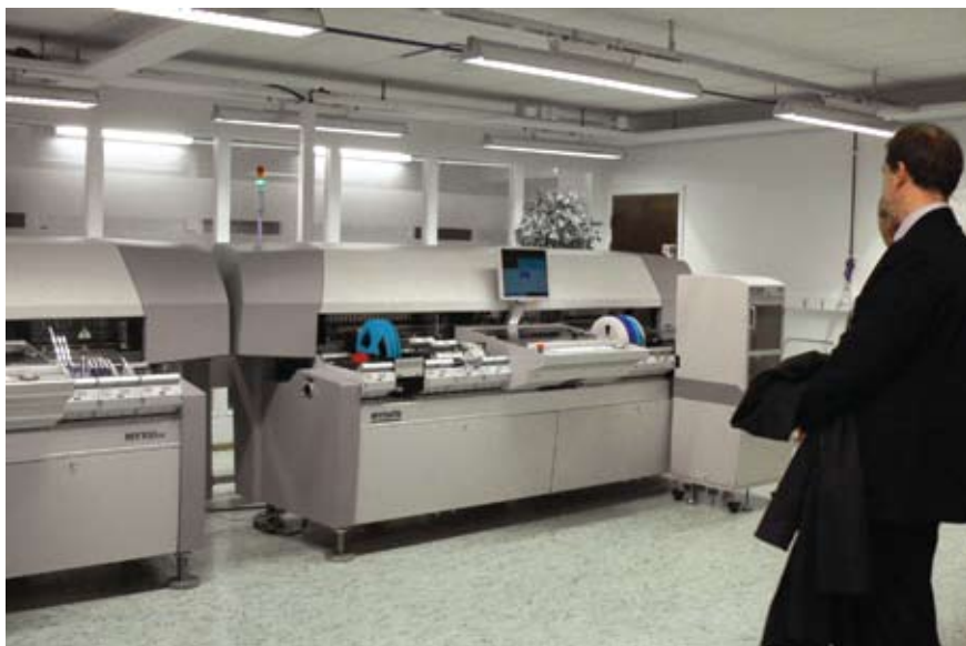
Рис. 3. Установщики компонентов в демозале
